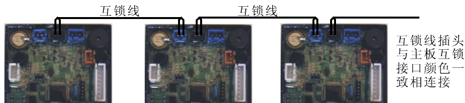
图3-9 互锁的接线图
